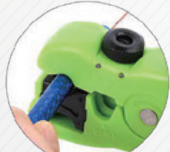
剥有线电视线
