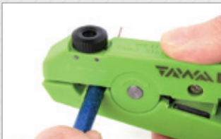
剥有线电视线
